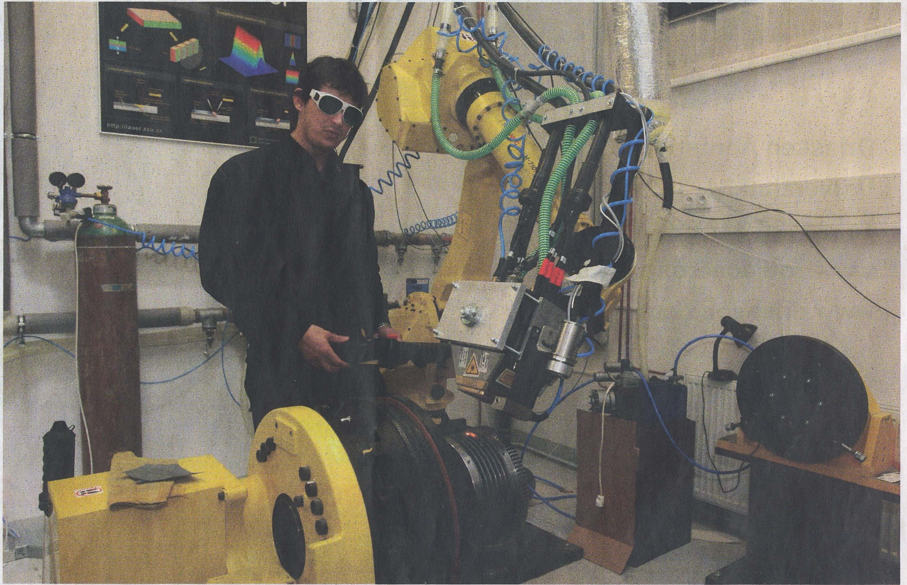
ROBOTIZOVANÉ PRACOVÍŠTĚ s 4 kW diodovým laserem používané pro vývoj nových technologií povrchového tepelného zpracování strojních součástí. Foto: Deník/ Vlastimil Leška
